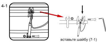
С помощью винта (7) и гайки (8) закрепите газовую пружину на связующем механизме (С), а затем на задней столешнице (В), используйте для этого ключ Аллена (2) и ключ (3)
