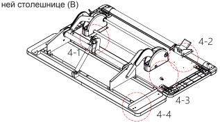
Посредством связующего механизма (С) соедините столешницы (А) и (В), используйте винт (9) и ключ (1)
